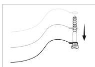
Inserire il cavo anticaduta tra la vite e la molletta Insert the fall arrest cable between the screw and the clip
